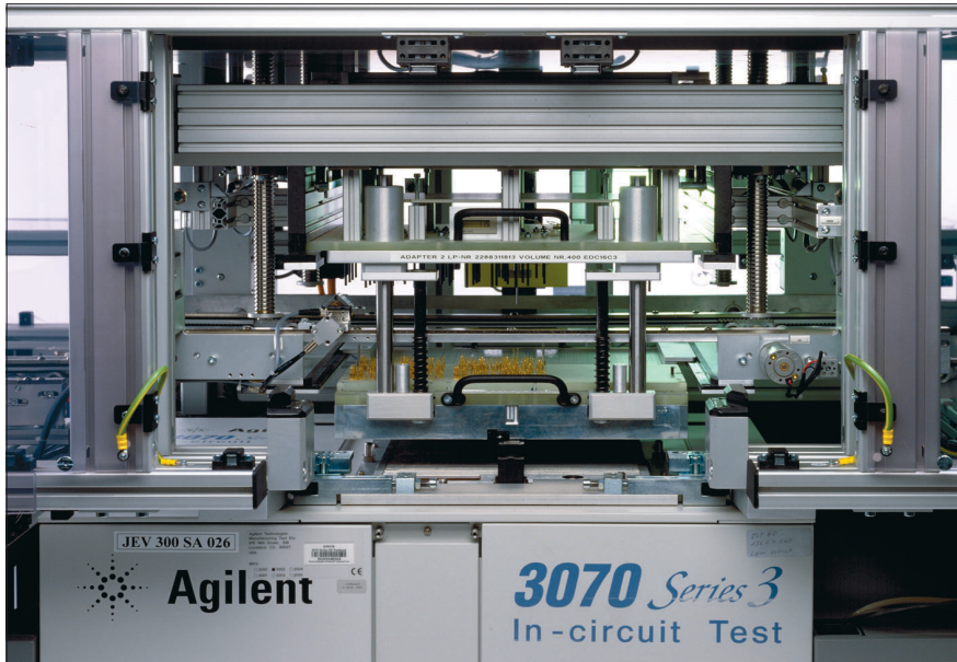
Prüfstation Agilent 3070, Kontaktierung mit Adaption
